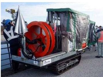
写真-2 橋梁点検支援ロボット
