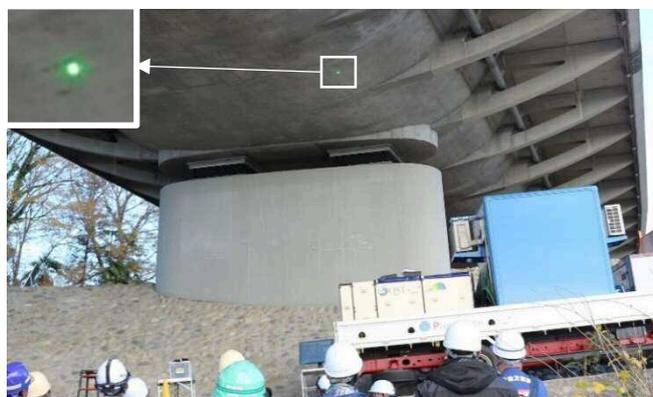
写真-1 レーザー打音技術の実演<sup>1)</sup>
